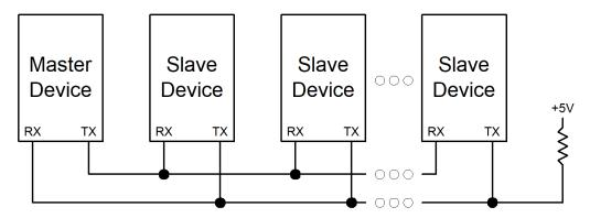
Figure 21.7. UART Multi-Processor Mode Interconnect Diagram
