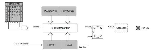
Figure 24.9. PCA 16-Bit PWM Mode
