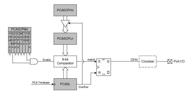
Figure 24.8. PCA 8-Bit PWM Mode Diagram
