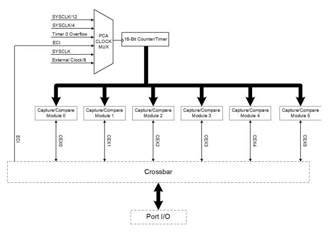
Figure 1.12. PCA Block Diagram
