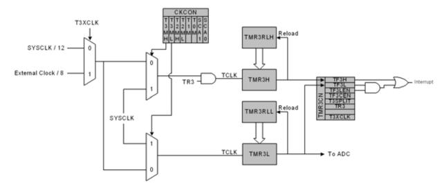
Figure 24.8. Timer 3 8-Bit Mode Block Diagram
