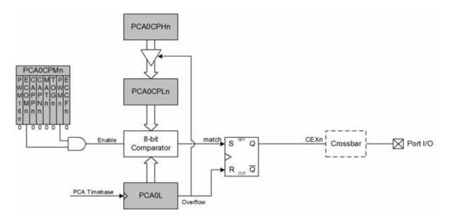
Figure 25.8. PCA 8-Bit PWM Mode Diagram
