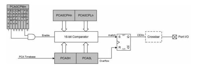
Figure 25.9. PCA 16-Bit PWM Mode
