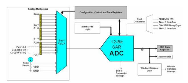
Figure 1.7. 12-Bit ADC Block Diagram
