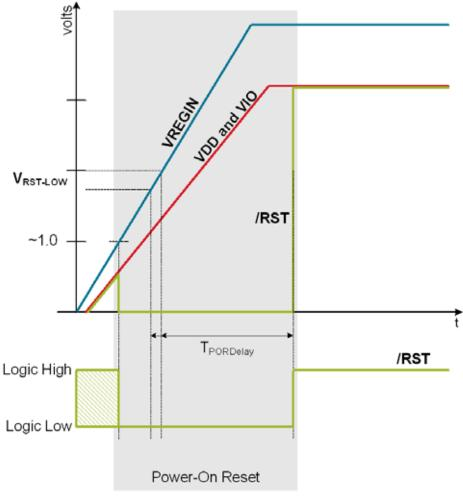
Figure 15.2. Power-On Reset Timing
