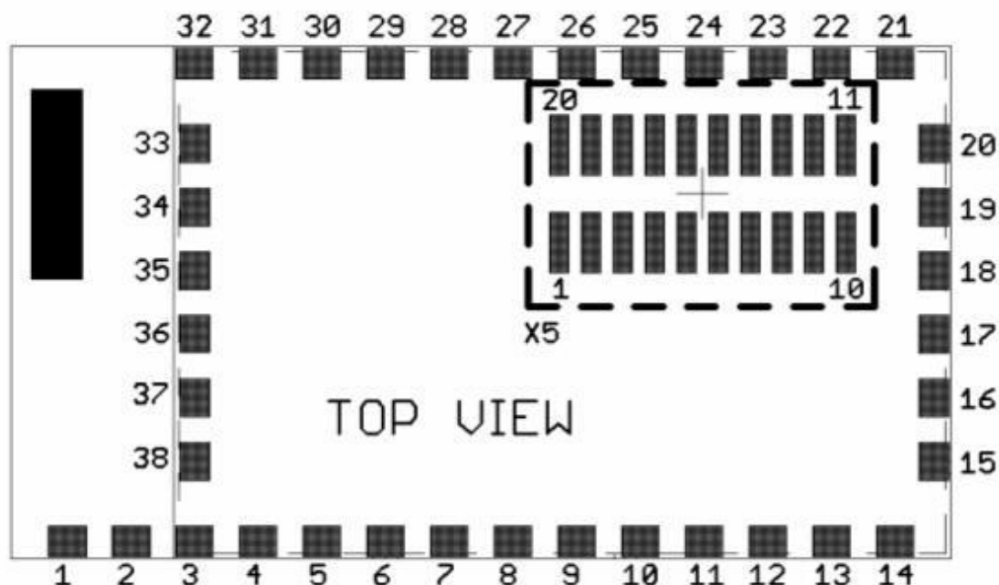
Figure 1: ETRX2 Module Pinout
