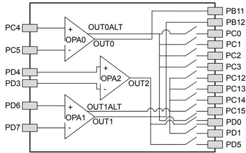
Figure 5.28. Opamp Pinout
