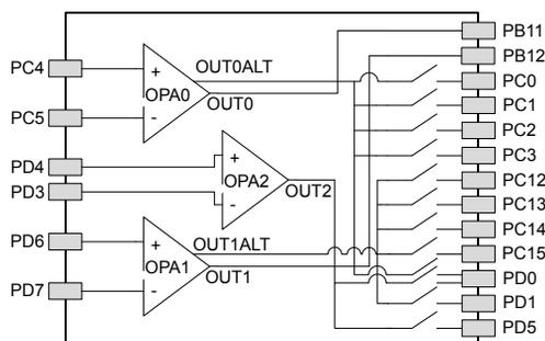
**Figure 5.16. Opamp Pinout**
