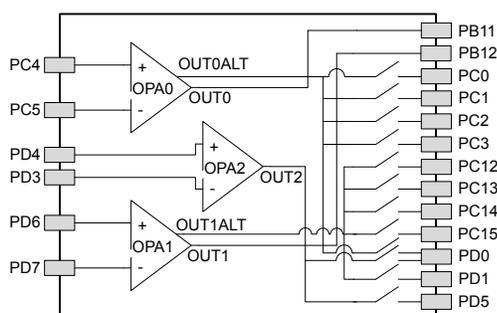
Figure 5.30. Opamp Pinout
