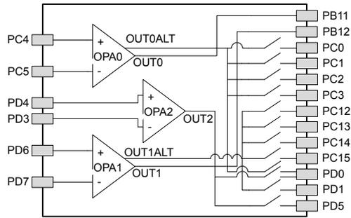
Figure 5.32. Opamp Pinout
