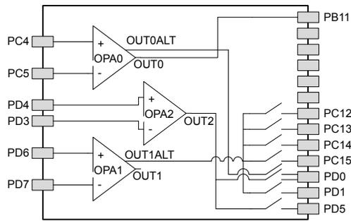
**Figure 5.36. Opamp Pinout**
