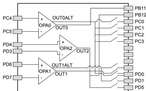
**Figure 5.18. Opamp Pinout**
