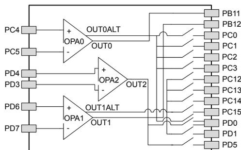
**Figure 5.10. Opamp Pinout**
