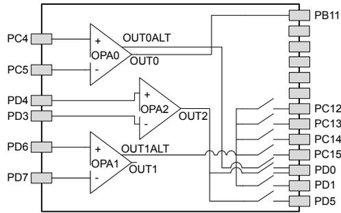
Figure 5.24. Opamp Pinout
