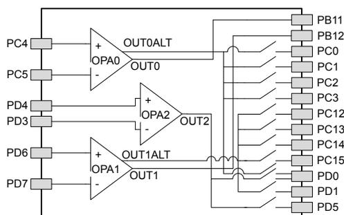
**Figure 5.6. Opamp Pinout**
