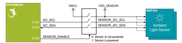
Figure 3.10. BMP384 Absolute Pressure Sensor
