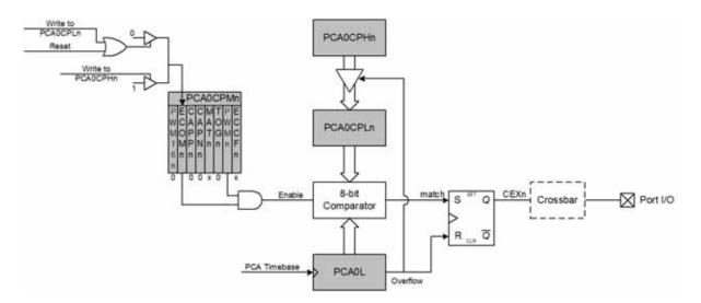
Figure 22.8. PCA 8-Bit PWM Mode Diagram
