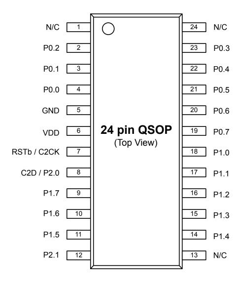
Figure 6.1. EFM8BB1x-QSOP24 Pinout
