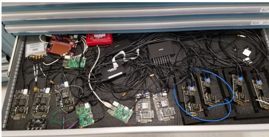
Figure 3.1. 抽屉中带分线器和同轴电缆连接的有线 RF 设备
