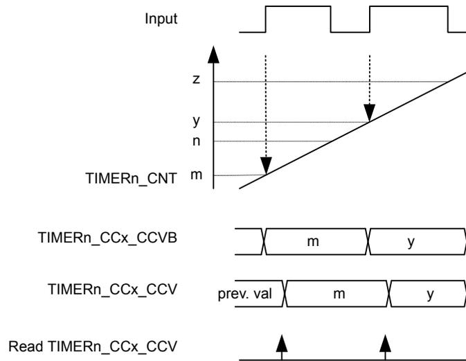
**Figure 19.12. TIMER/WTIMER Input Capture**
