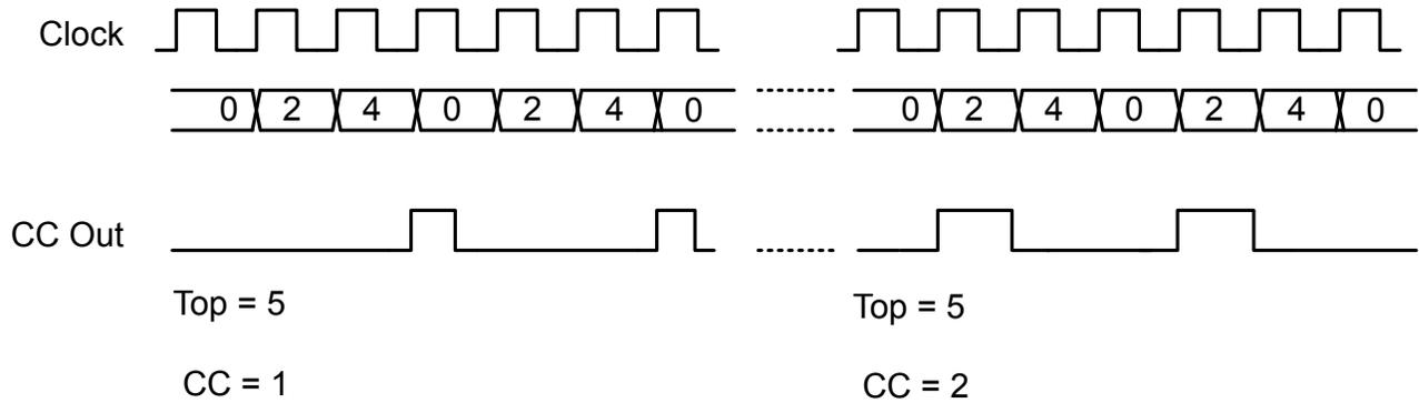
**Figure 19.25. TIMER/WTIMER CC out in 2x mode**
