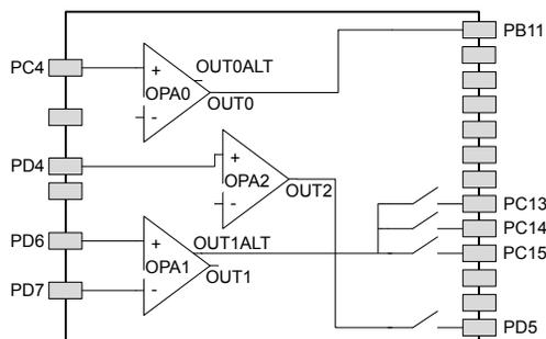
**Figure 5.15. Opamp Pinout**
