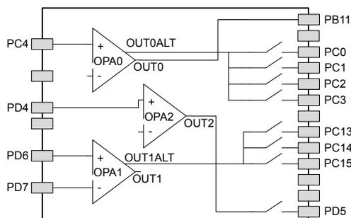
Figure 5.7. Opamp Pinout
