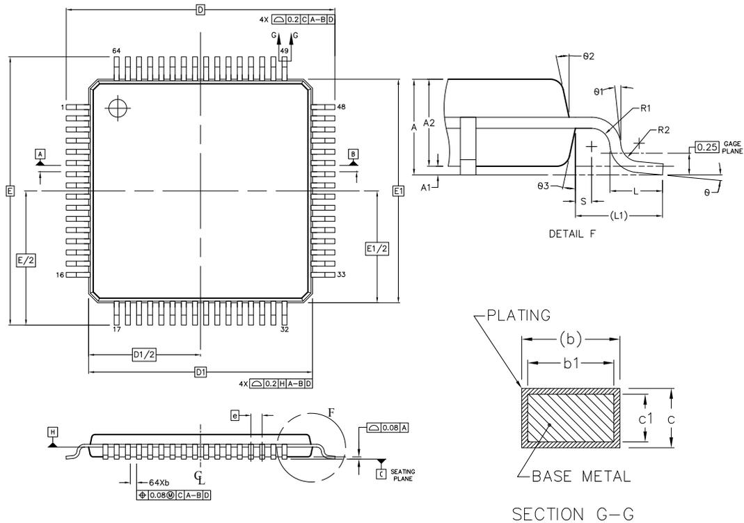
Figure 11.1. TQFP64
