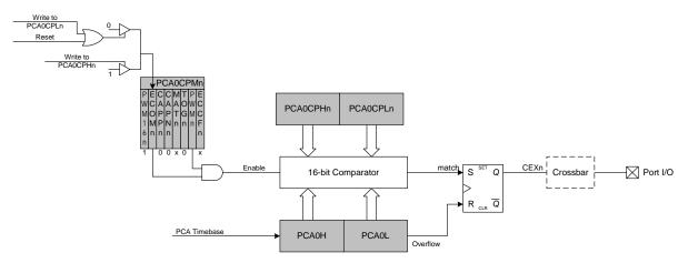
Figure 20.9. PCA 16-Bit PWM Mode
