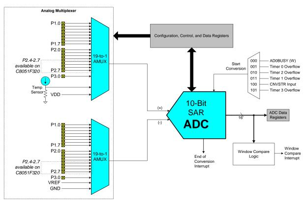
Figure 1.10. 10-Bit ADC Block Diagram
