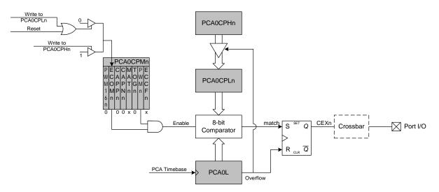
Figure 20.8. PCA 8-Bit PWM Mode Diagram
