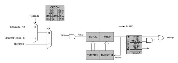
Figure 19.8. Timer 3 16-Bit Mode Block Diagram
