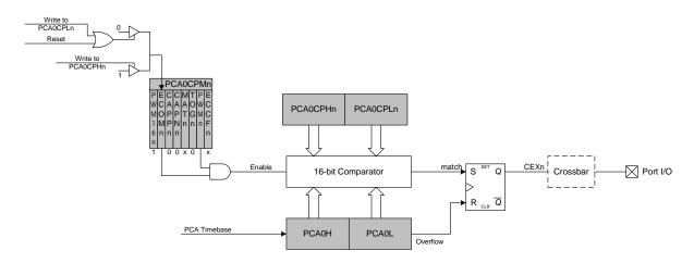
Figure 19.9. PCA 16-Bit PWM Mode
