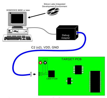
Figure 1.10. Development/In-System Debug Diagram
