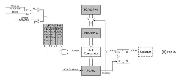
Figure 19.8. PCA 8-Bit PWM Mode Diagram
