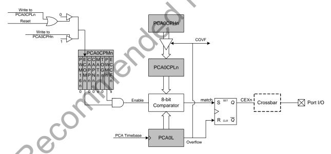
Figure 26.8. PCA 8-Bit PWM Mode Diagram
